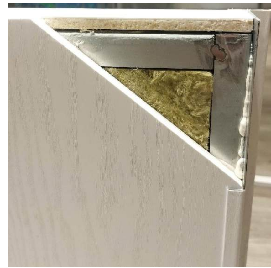
4. Kết cấu Cánh HGF Laminate
